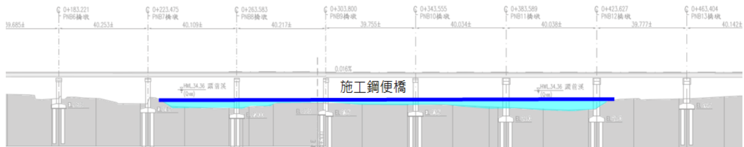
施工鋼便橋立面示意圖
