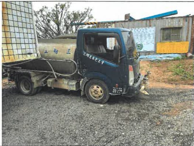
說明：灑水車定時定期噴灑路面 日期：110/03/09
