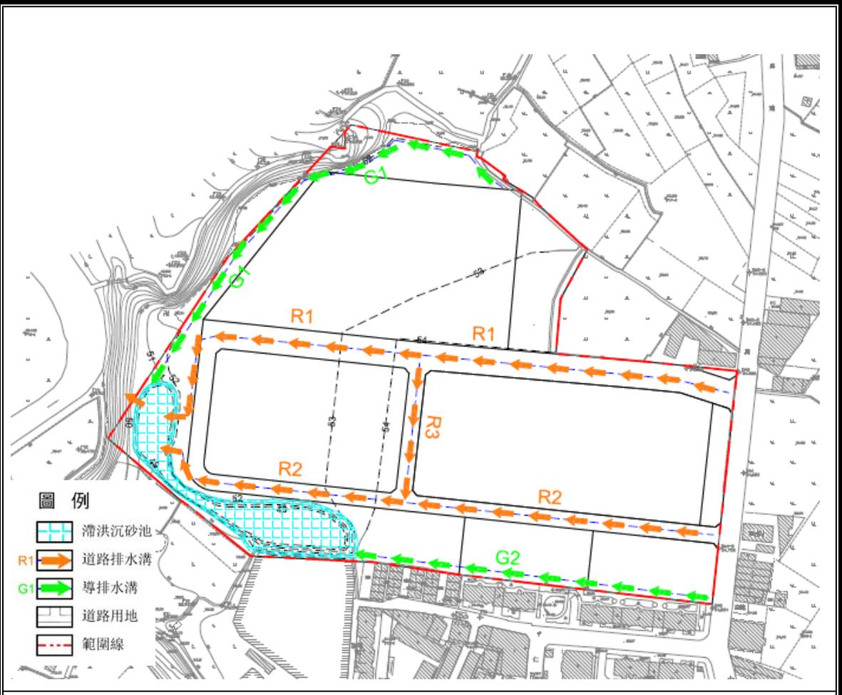
圖 8-3 變 9 案雨水排水系統規劃示意圖
