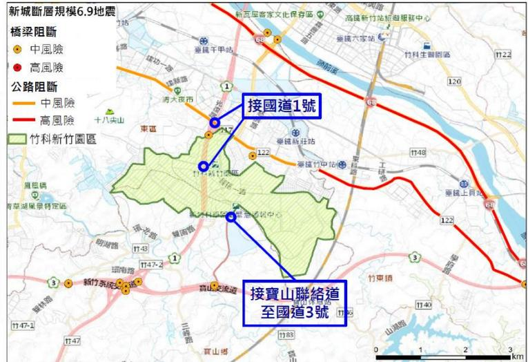
圖 8 新城斷層規模 6.9 地震竹科附近道路阻斷影響
